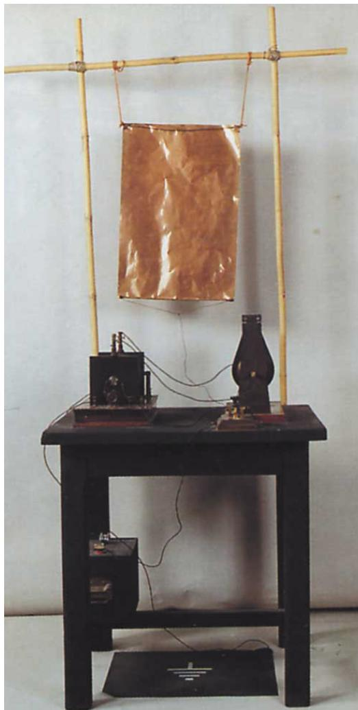
Fig. 9 - Ricostruzione con apparati coevi del trasmettitore utilizzato per l'esperimento di Pontecchio del 1895. Museo della Radio e della Televisione-RAI, Torino
