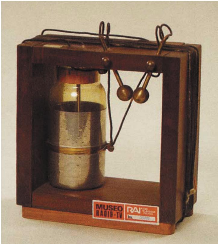
Fig. 10 - Modello del circuito sintonico di Marconi (brevetto 7777, del 1896).
