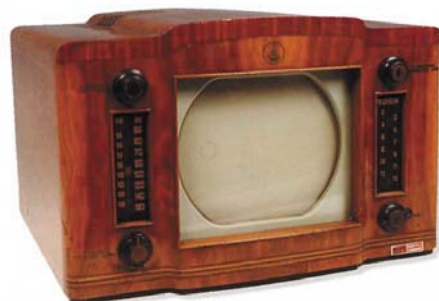
Fig. 6 - Televisore B/N Emerson, modello 606 (U.S.A.), schermo 10", cinescopio circolare, 23 valvole, standard a 525 linee di definizione, Radioricevitore MA – MF (1948). Museo della Radio e della Televisione - RAI, Torino.
