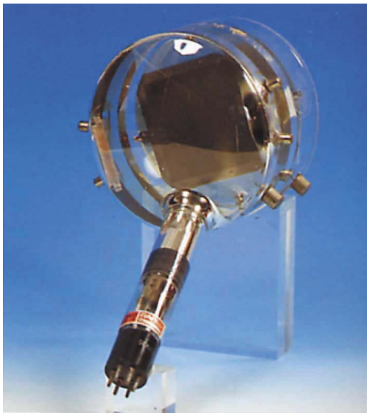
Fig. 4: Iconoscopio di Zworykyn, progenitore della tv elettronica, costruzione R.C.A./U.S.A. (1935). Museo della Radio e della Televisione - RAI, Torino.
