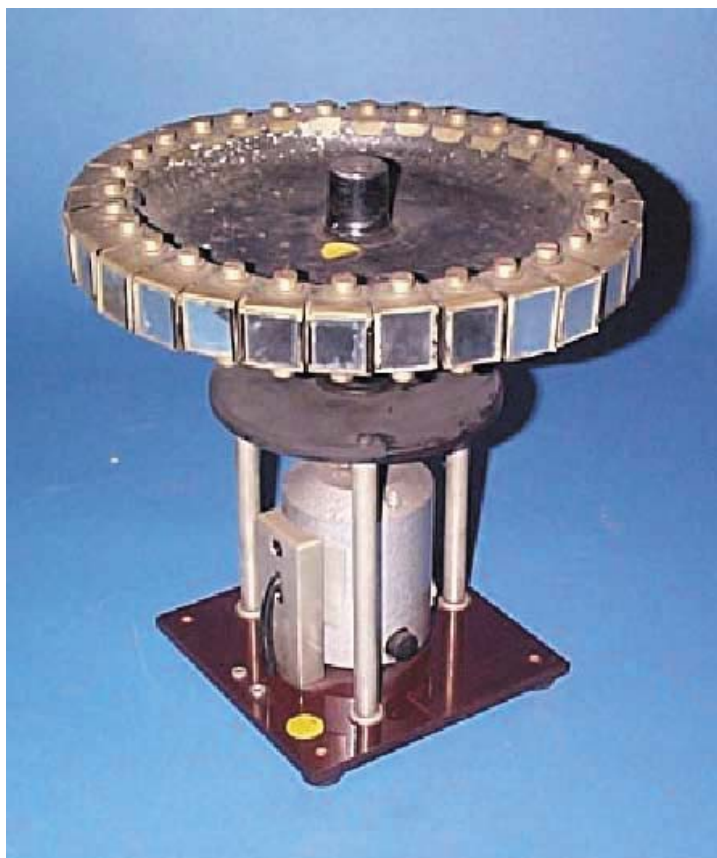
Fig. 2 - Sistema di trasmissione televisiva a specchi. Museo della Radio e della Televisione - RAI, Torino.
