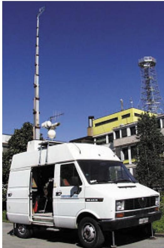
Fig. 4 - Automezzo attrezzato per le misure in ricezione fissa
