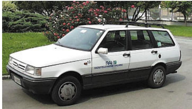
Fig. 7 - Auto attrezzata per le misure in ricezione mobile
