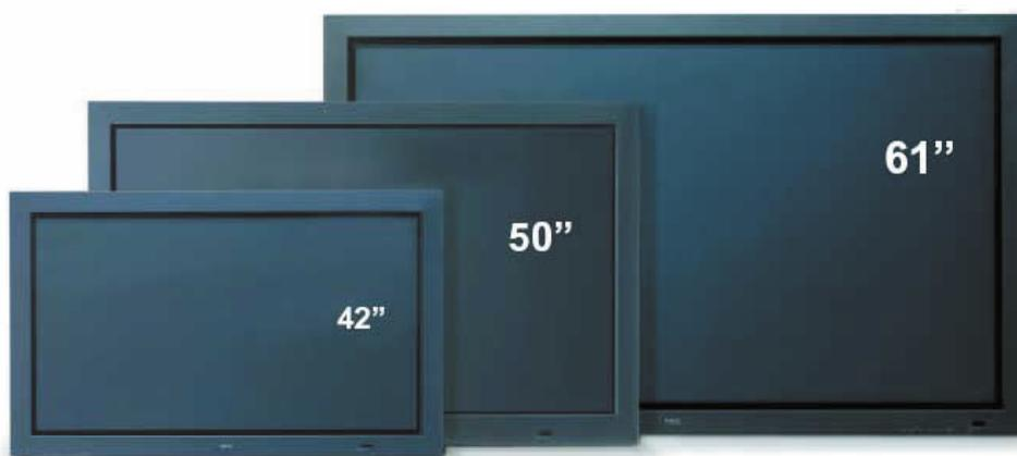
Fig. 4 - Dimensioni di PDP a 42", 50" e 61" a confronto. Caratteristiche del PDP PlasmaSync MP1 (NEC) da 61": 16:9, 1366 x 768 pixel, peso 61 kg, consumo 660 W, profondità 119 mm, da notare il basso livello di rumore acustico, dovuto ai ventilatori per il raffreddamento, 22 dB).
