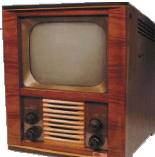
1952 - Televisore B/N Philips mod. "TD 1410 U", schermo rettangolare, 24 valvole: utilizzato in Rai agli esordi come monitor di controllo.
