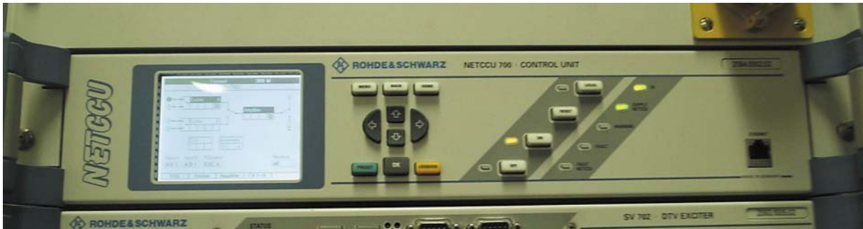
Fig. 7 - Foto della logica di controllo del trasmettitore DVB-T denominata NETCCU.
