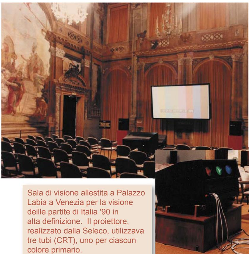
Sala di visione allestita a Palazzo Labia a Venezia per la visione delle partite di Italia '90 in alta definizione. Il proiettore, realizzato dalla Seleco, utilizzava tre tubi (CRT), uno per ciascun colore primario.
