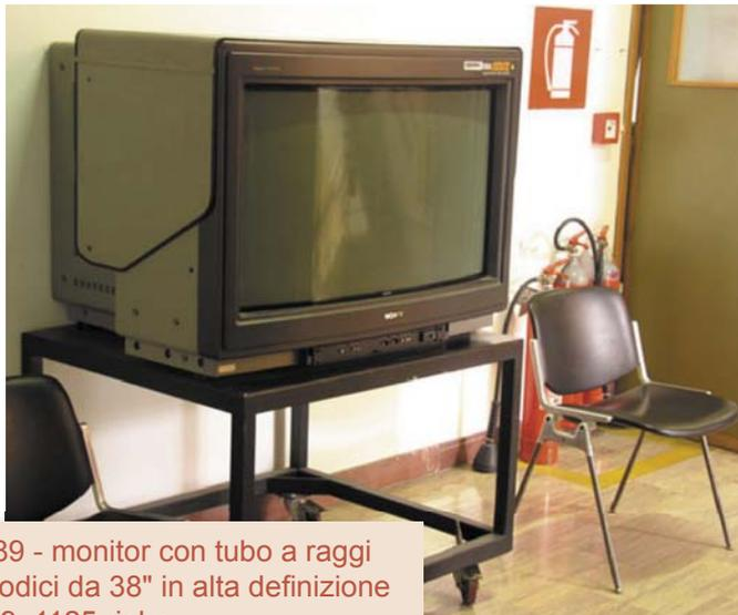
1989 - monitor con tubo a raggi catodici da 38" in alta definizione 16:9, 1125 righe, dimensioni 1030 x 764 x 865 mm, peso 184 kg, 350 W (Sony HDM 3830)
