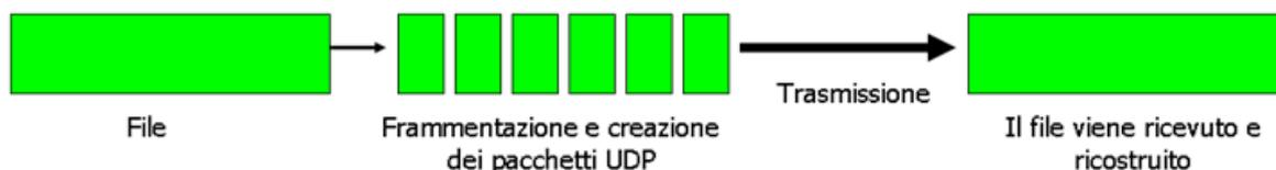
Fig. 12 - Principio del protocollo FLUTE.
