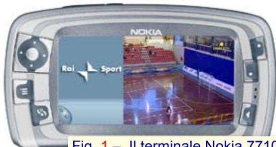
Fig. 1 – Il terminale Nokia 7710 con il ricevitore SU-22.
