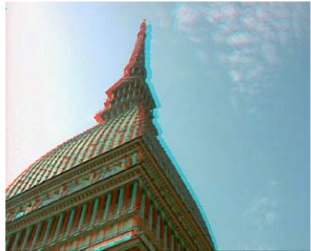
Fig. 5 – Immagine stereoscopica generata col metodo degli anàglifi; il canale sinistro (per l'occhio sinistro) è colorato in rosso, quello destro in ciano.
