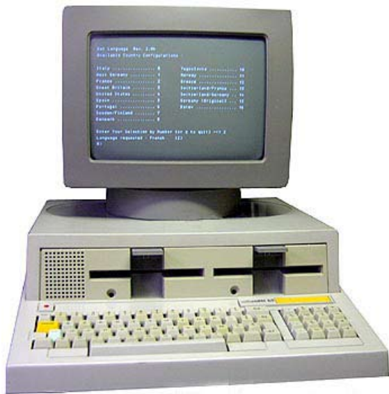
Fig. 1 - Olivetti M20 – Commercializzato dalla Olivetti nel 1982 – Disponeva di un piccolo altoparlante per dare conferme acustiche e segnalare malfunzionamenti.
