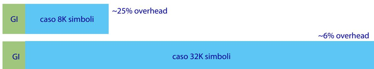
Fig. 10 - Rappresentazione della durata del simbolo nel caso di 8K e 32K portanti. In entrambi i casi l'intervallo di guardia è circa 224  $\mu$ s e consente la realizzazione di SFN con distanza tra i trasmettitori di circa 70 km.
