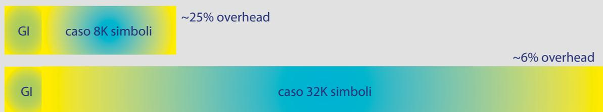
Fig. 7 - Confronto DVB-T vs DVB-T2 per una rete a singola frequenza. In entrambi i casi l'intervallo di guardia è circa 224  $\mu$ s e consente la realizzazione di SFN con distanza tra i trasmettitori di circa 70 km.
