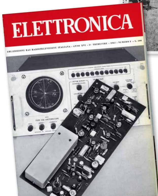
1967 - Decodificatore per televisione a colori sistema PAL, realizzato dal Laboratorio Ricerche della Rai. E' ben visibile la linea di ritardo che è del tipo a ritardo esatto prearato. In secondo piano appare un vettorscopio, strumento fondamentale nella televisione a colori.
