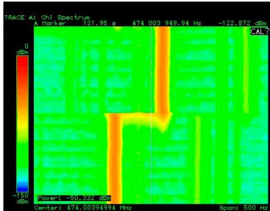
Fig. A7 - Spettrogramma del segnale *clean carrier* affetto da *Doppler shift*. In ascissa è la frequenza, in ordinata il tempo (in basso il più recente), e in scala di colori il livello, funzione di tempo e frequenza.
