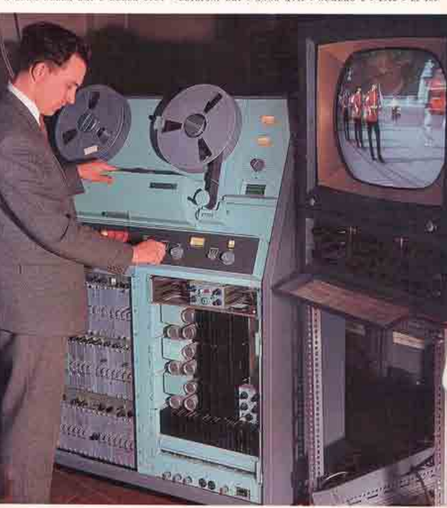
Video-recorder AMPEX usato nei Laboratori della BBC di Londra per esperimenti di televisione a colore.
