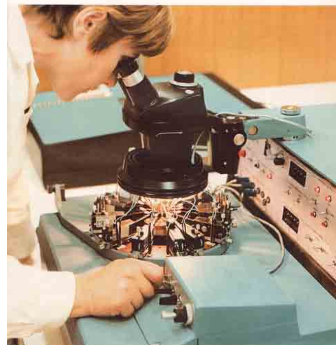
Sonda multipla per il collaudo dei circuiti integrati su fetta di silicio
