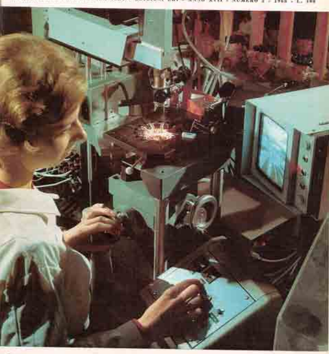
Saldatura del "chip" di un circuito integrato al substrato del contenitore.
