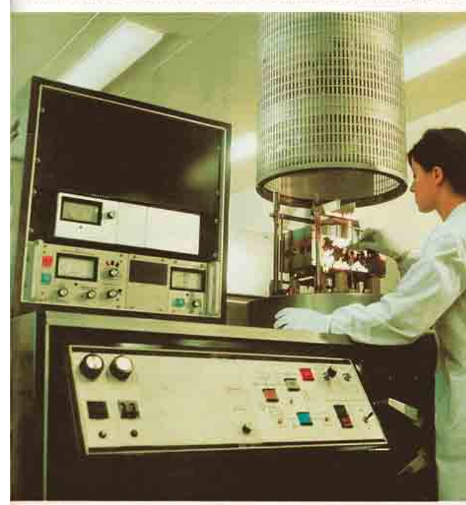
Apparecchiatura ad alto vuoto per la deposizione, con il processo di vaporizzazione, dei contatti metallici sulle piastrine di silicio.
