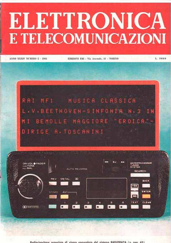
Radiorecettore provvisto di visore comandato dal sistema RADIODATA (v. pag. 63)
