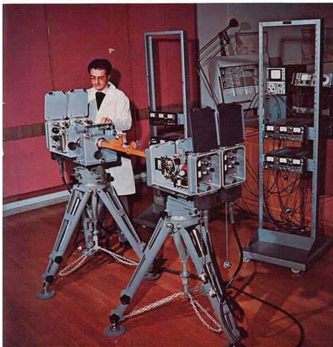
Ponte radio doppio di tipo portatile, per riprese esterne TV anche a colori (v. pag. 80).
