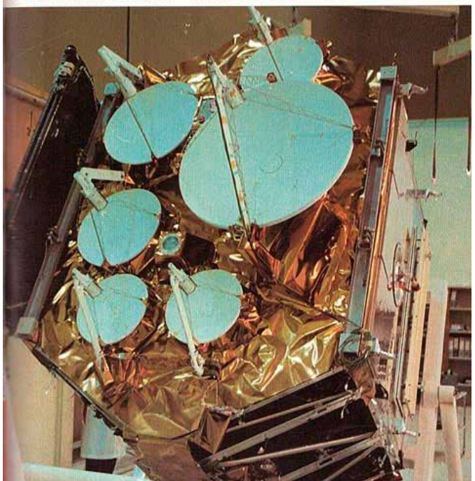
Satellite europeo OTS per telecomunicazioni nelle bande 11 e 14 GHz (v. art. a p. 203).
