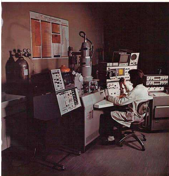
Microscopio Elettronico a Scansione (SEM) con spettrometri a raggi X (v. articolo a pag. 2).
