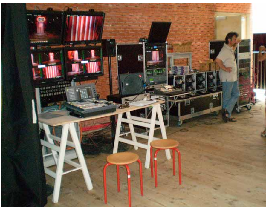
Fig. 3 - Il dispiegamento degli apparati costituenti la regia stereoscopica. Da sinistra: il banco mixer, il sistema di misura e taratura, il banco di registrazione e il sistema di trasmissione.
