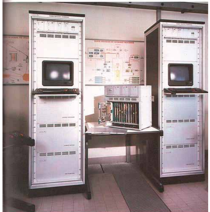
Prototipo di elaboratore di bordo per satellite con stadi Tempo-Spazio-Tempo (v. art. a pag. 254)
