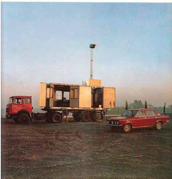
Base mobile per il radiorilevamento delle prestazioni di autovetture su strada a 400
