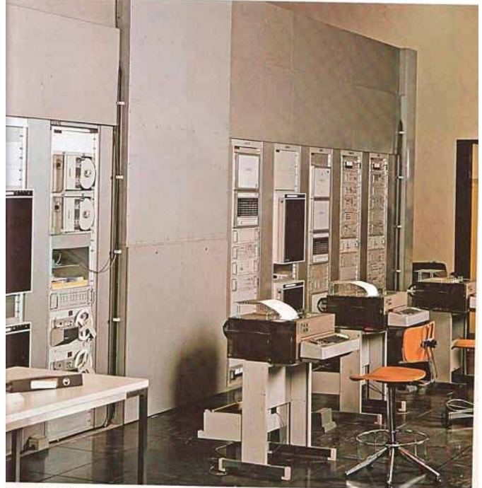
Una parte parziale dell'impianto CATTO (Contabilità Automatica Traffico Telefonico da Operatore) (art. a p. 235)
