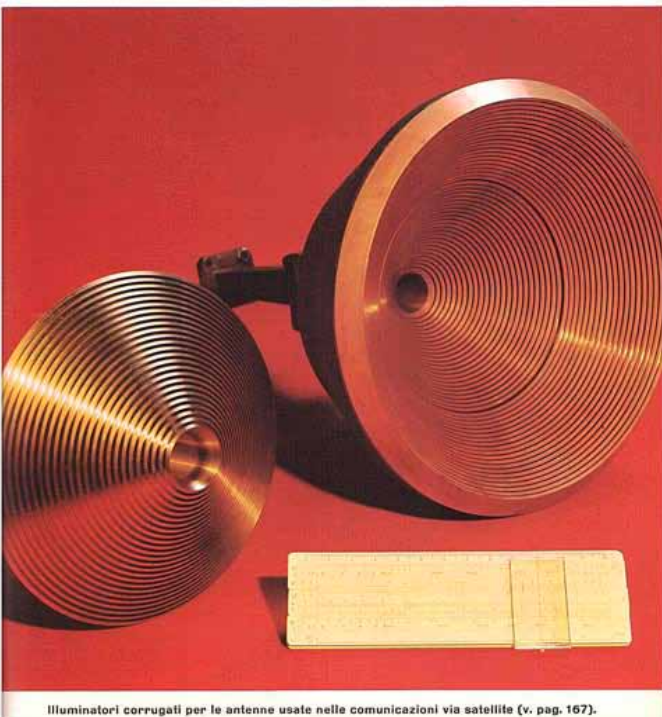
Illuminatori corrugati per le antenne usate nelle comunicazioni via satellite (v. pag. 167).
