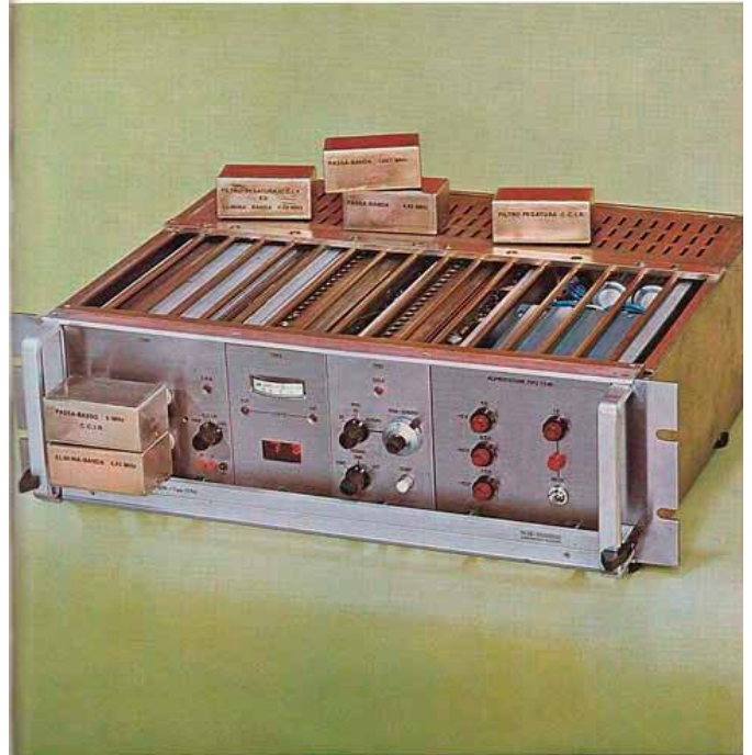
Misuratore automatico del rapporto segnale-rumore di un segnale video (v. articolo a pag. 206)
