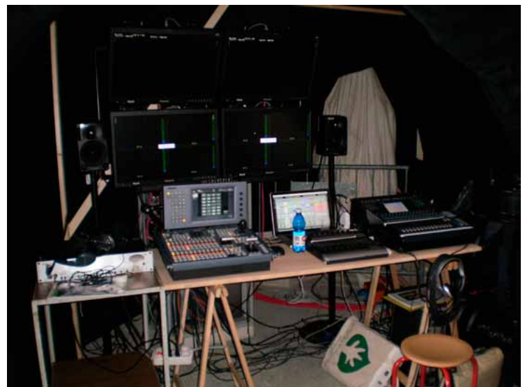
Fig. 1 - Banco regia. Da sinistra: centralina interfono, banco mixer video, banco mixer audio.
