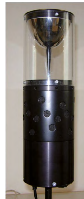
Fig. 5 - Esempio di schiera di capsule microfoniche (a) e schema della disposizione pseudo-casuale sulla superficie (b).
