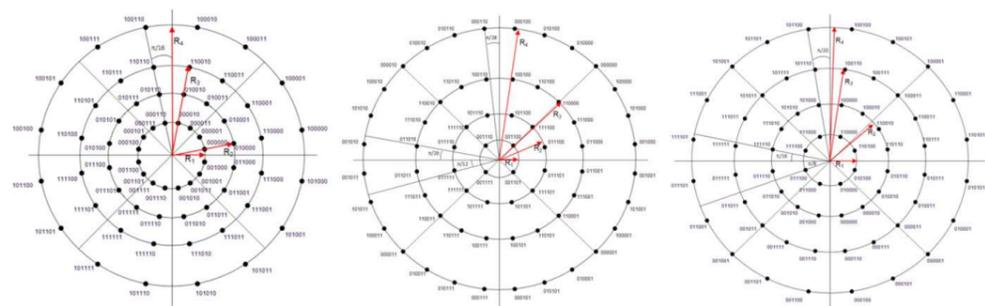
Fig. 3 – Differenti realizzazioni della costellazione 64APSK del DVB-S2X
