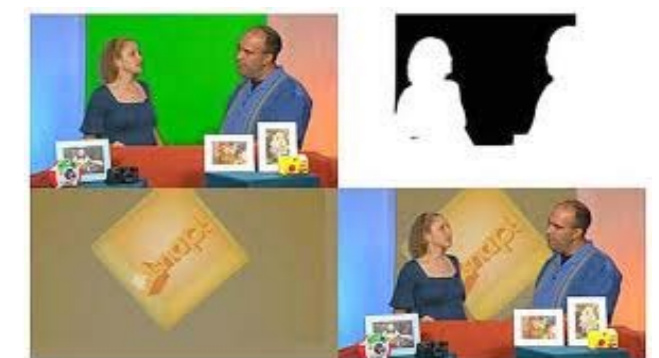
Fig. 7 – Foreground , alpha channel e (destra in basso) immagine composta ( chroma key nella parte centrale dello sfondo e alpha key sui personaggi e sul tavolo) [6]
