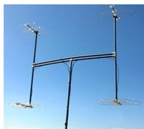
Fig. 1 – Illustrazione schematica del link (sinistra) e immagine di una delle due UCA utilizzate nell'esperimento (destra)
