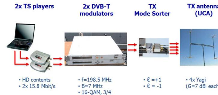
Fig. 8 – Setup della postazione trasmittente
