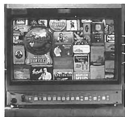
Fotografia eseguita su cinescopio di televisione ad alta definizione. I limiti fotografici impediscono in questa fotografia di apprezzare tutti i dettagli dell'immagine originale. Le righe di scansione sono 1250 secondo lo standard HDTV europeo 1250/50/2:1. I rapporti di immagini non sono ancora quelli proposti ufficialmente (16 a 9). Nell'articolo di pagina 50 si analizzano i vari standard proposti (foto Valesio).
