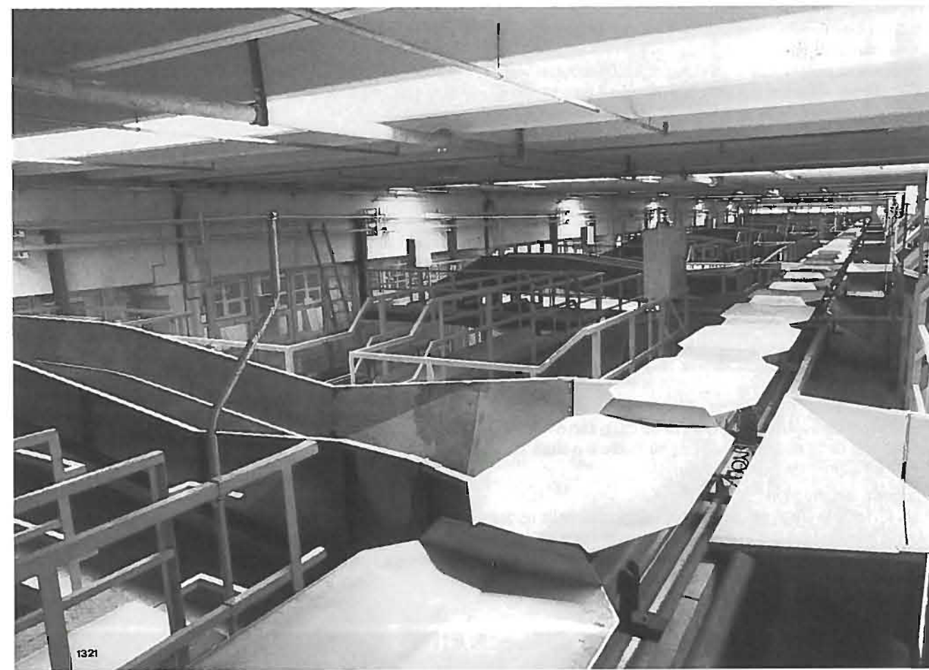
Fig. 6 — Vista dei piattelli costituenti la macchina smistatrice.
