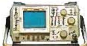
**Tek 490** - Serie di analizzatori portatili a norme MIL, per frequenze da 100 Hz a 325 GHz.
