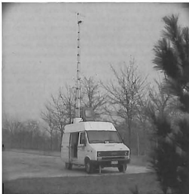
Fig. 7 — Furgone Fiat Iveco tipo Daily attrezzato con palo telescopico che raggiunge un'altezza massima di 20 m.
