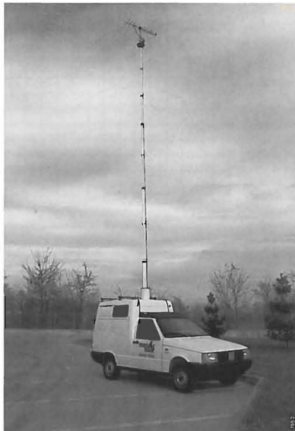
Fig. 6 — Automezzo Fiat Fiorino tipo furgone attrezzato per le misure radioelettriche e per il controllo video-audio sui segnali emessi. Il palo telescopico raggiunge un'altezza di 10 m (12 m a richiesta).
