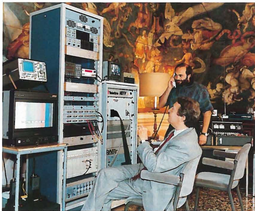
Fig. 6 — Appareti di conversione di frequenza, demodulazione e decodifica audio e video ubicati nella Sede RAI a Palazzo Labia (Venezia).
