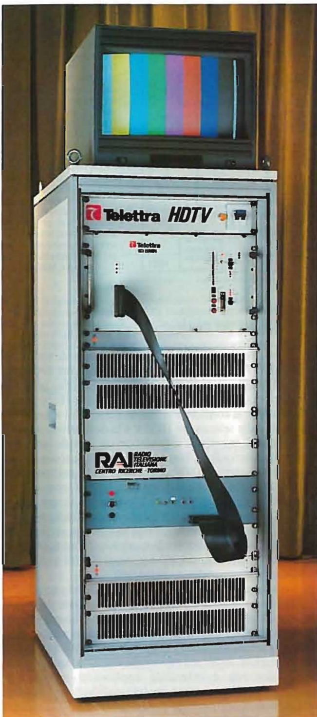
Fig. 3 — Uno dei codificatori HDTV utilizzati per Italia '90. L'unità di conversione analogico/numerica, realizzata presso il Centro Ricerche RAI, fornisce il segnale numerico mediante un'interfaccia parallela su 16 bit più il clock al codificatore realizzato dalla Telettra. Il codificatore è racchiuso in un sottotelaio da 19" di larghezza e 6 unità di altezza. Il consumo è pari a circa 200 W. Le schede componenti il codificatore sono di 230 per 280 mm. Il flusso di dati in ingresso è suddiviso da una scheda di interfaccia nei quattro flussi corrispondenti ai segmenti verticali in cui è suddivisa l'immagine. Ciascun flusso è elaborato da due schede: la prima calcola i valori di predizione, sceglie il modo di codifica e calcola i coefficienti DCT; la seconda scheda codifica i coefficienti con parole VLC e le memorizza in un buffer di 4 Mbit. La scheda del controllore del buffer gestisce l'insieme dei quattro buffer appartenenti alle unità di codifica. Un'altra scheda provvede ad aggiungere la ridondanza per il codice per la protezione dagli errori di canale e a moltiplicare i dati provenienti dalle quattro unità di codifica video e da quella per la codifica dei segnali audio e dati ausiliari.
