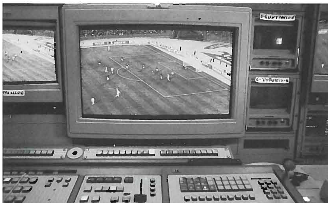
Fig. 2 — Particolare del banco di regia all'interno del mezzo mobile BTS in cui è stato inserito il maggior numero di monitori ad Alta Definizione per consentire l'ottimale direzione di tutte le sorgenti televisive disponibili.
