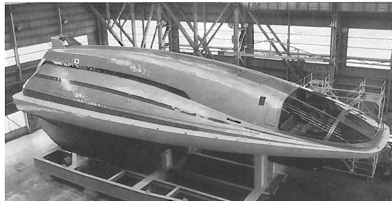
Fig. 8 — Nave YAMATO-1 a propulsione magnetica. (Fotografia tratta da Superconductor Industry).
