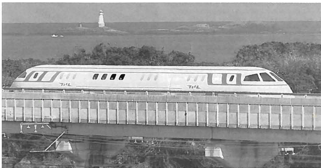
Fig. 7 — Treno giapponese MLU002 a levitazione magnetica. (Fotografia tratta da Superconductor Industry).
