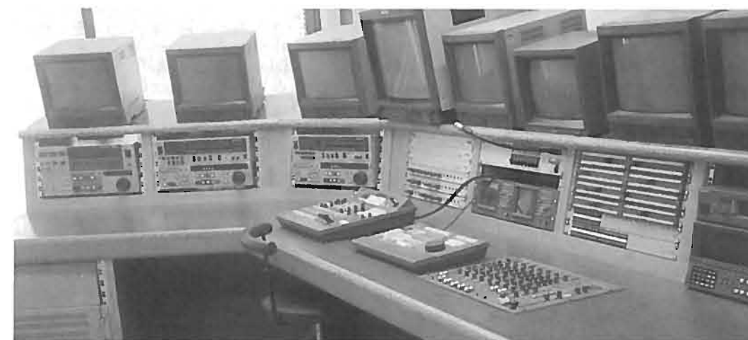
Fig. 14 — Sala di post-produzione con centralina, mixer audio, mixer video.
