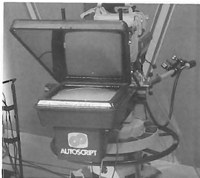
Fig. 3b — Particolare della telecamera equipaggiata con teleprompter.
