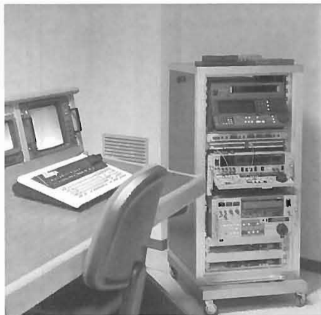
Fig. 8 — Carrello, nella regia video, sul quale sono montati tre videoregistratori per la messa in onda di eventuali contributi registrati.
