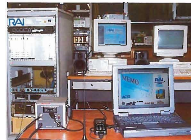
Fig. 14 - Fotografia del terminale d'utente MEMO (in primo piano), del BNS e degli apparati per la generazione, moltiplicazione e messa in onda del segnale DAB presso il Centro Ricerche RAI.
