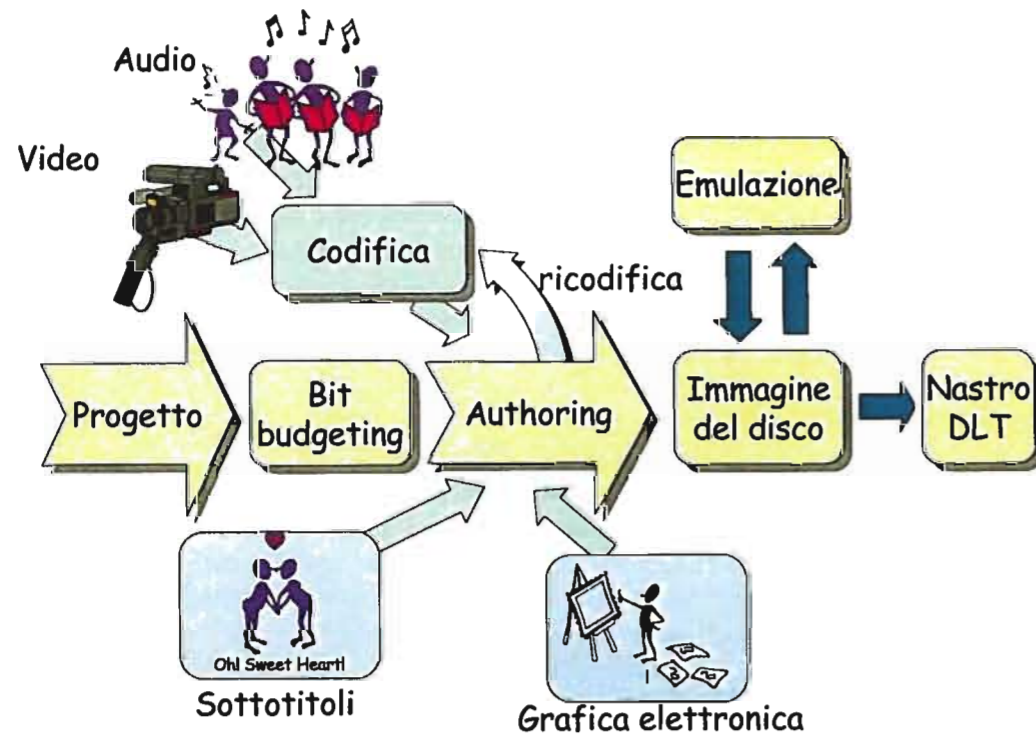
Fig. 10 - Schema del processo di pre-mastering del DVD Video.
