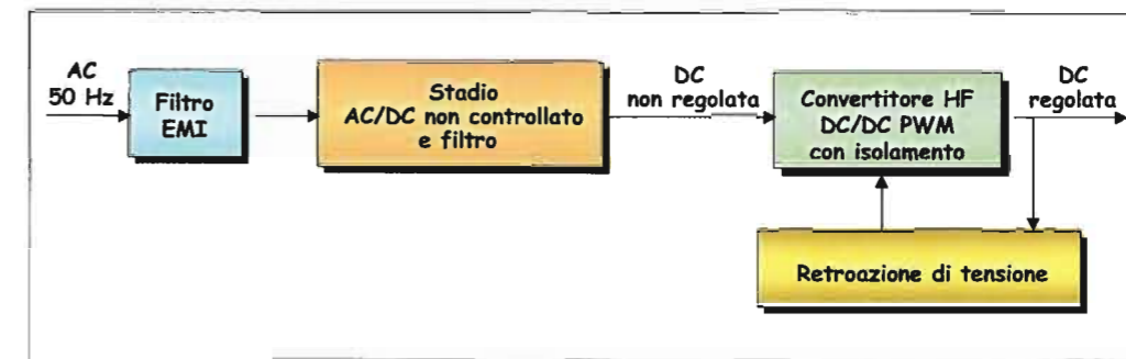
Fig. 1 - Schema di un alimentatore "switching".
