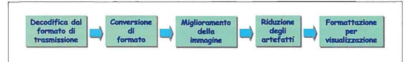
Fig. 9 - Schema di flusso generico che rappresenta le elaborazioni a cui è soggetto il segnale video per adattarlo alla visualizzazione.
