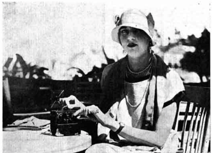
Questo minuscolo radioricevitore portatile consente un'ottima ricezione di stazioni entro un raggio di 100 km. Per l'audizione non occorre altro che la cuffia o l'altoparlante essendo tutti gli altri accessori contenuti nell'apparecchio stesso.
