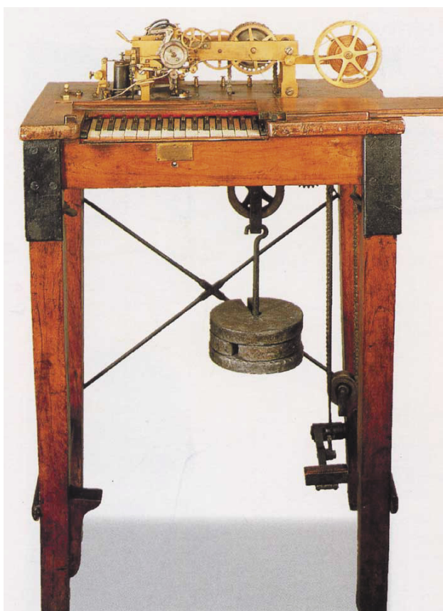
Fig. 3 - Apparato telegrafico scrivente, sistema HUGHES, azionato da movimento per gravità a caricamento di pesi di piombo, macchina a funzionamento sincronico con la ricevente, impiegata su linee a grande traffico grazie alla velocità di trasmissione. Telegrafo Hughes, Museo della Radio e della Televisione- RAI - Torino NOTA: oggetto originale, prestato dal Museo delle Poste.
