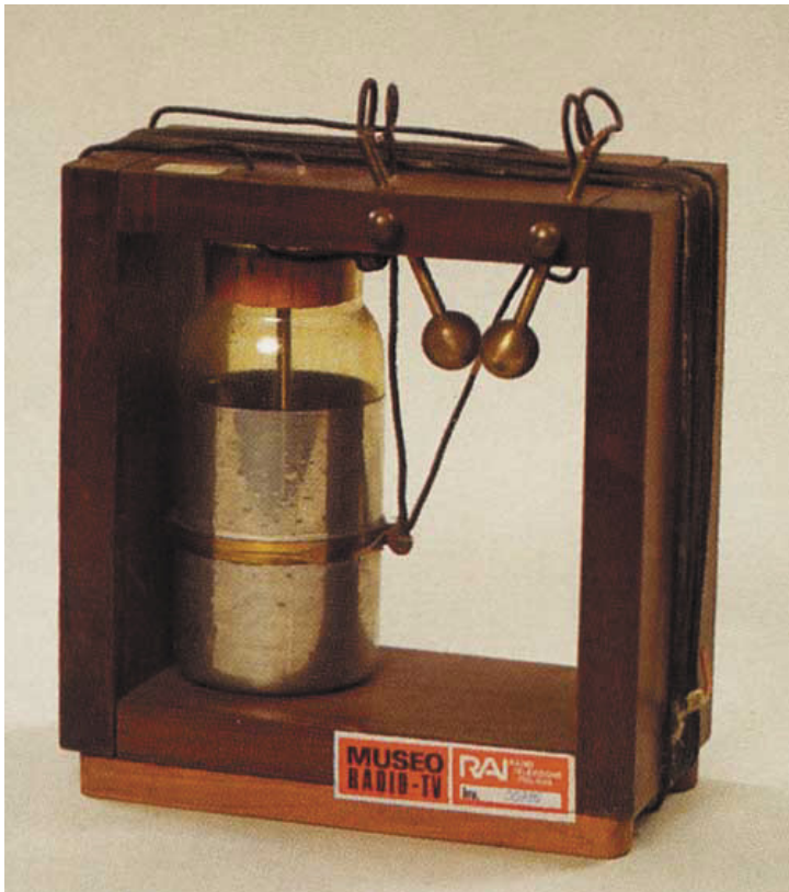
Fig. 10 - Modello del circuito sintonico di Marconi (brevetto 7777, del 1896). Museo della Radio e della Televisione-RAI, Torino
