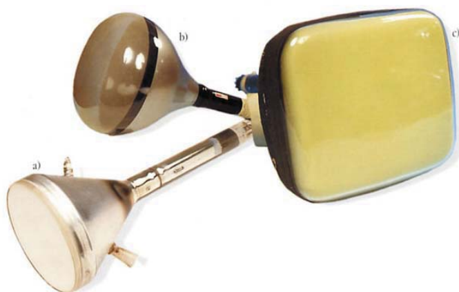
Fig. 5: Tre cinescopi europei per la televisione. In basso cinescopio EMI, modello R5161 (G.B. – 1937); a sinistra cinescopio SAFAR, modello VS 4/35 (I – 1938); a destra, cinescopio TELEFUNKEN, modello RFB/T2 (D – 1939), primo cinescopio rettangolare. Museo della Radio e della Televisione - RAI, Torino.
