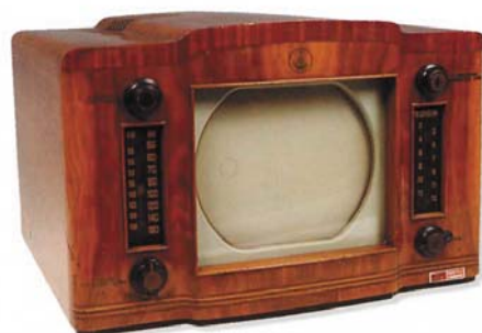
Fig. 6 - Televisore B/N Emerson, modello 606 (U.S.A.), schermo 10", cinescopio circolare, 23 valvole, standard a 525 linee di definizione, Radioricevitore MA – MF (1948). Museo della Radio e della Televisione - RAI, Torino.
