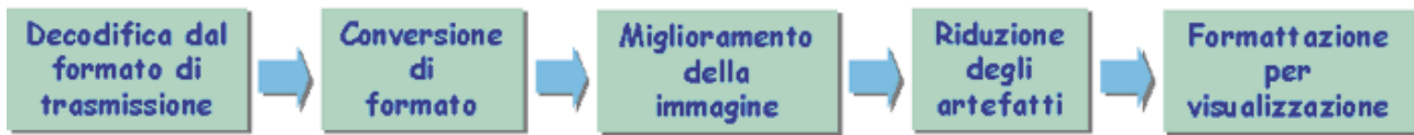
Fig. 8 - Schema di flusso generico che rappresenta le elaborazioni a cui è soggetto il segnale video per adattarlo alla visualizzazione
