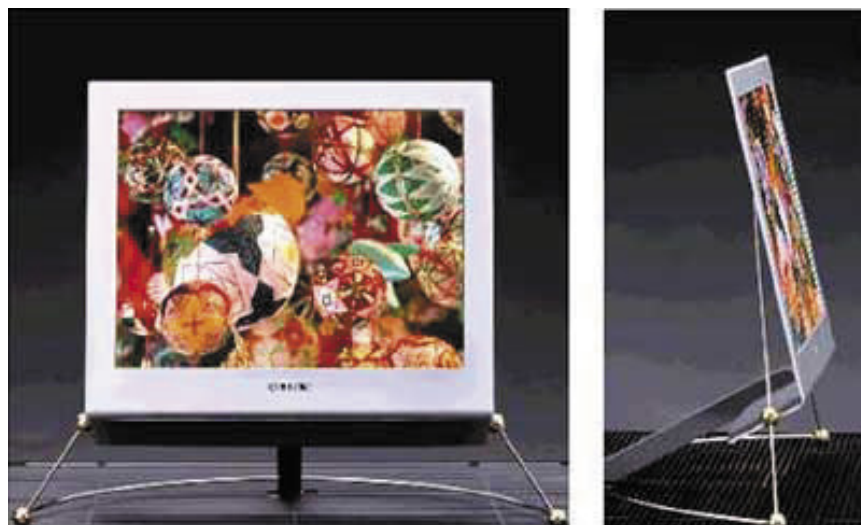
Fig. 2 - Prototipo di display OLED da 13" (SVGA 800 x 600, 1,4 mm di spessore, luminanza 300 cd/m 2 , contrasto 500:1) presentato dalla SONY al CEATEC nell'ottobre 2001.
