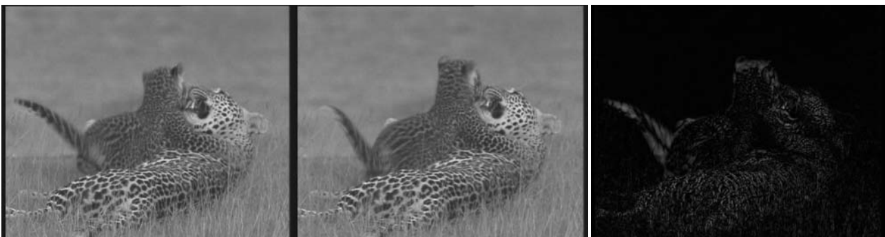
Fig. 5 - Due quadri successivi (sola luminanza) di una sequenza video e immagine differenza fra le due.
