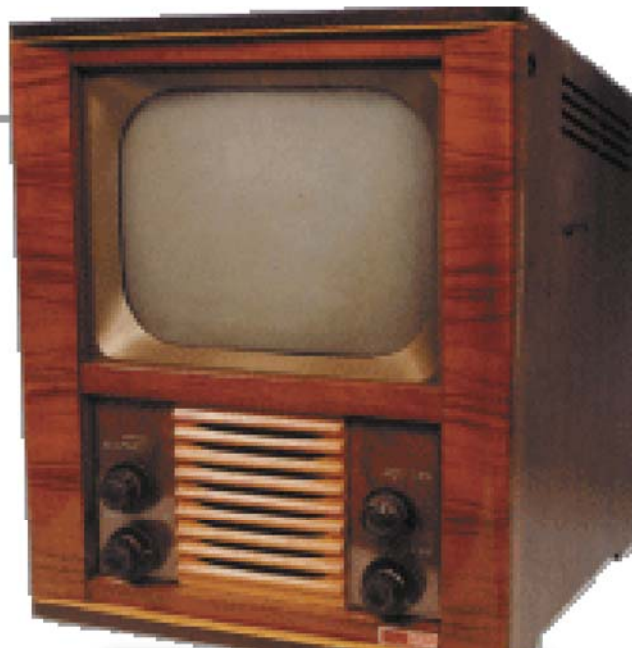
1952 - Televisore B/N Philips mod. "TD 1410 U", schermo rettangolare, 24 valvole: utilizzato in Rai agli esordi come monitor di controllo.
