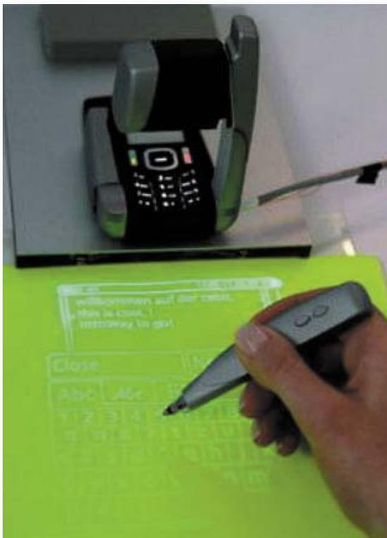
Fig. 2 - La penna, utilizzata per scrivere e per telefonare, è dotata di microfono e altoparlante, i segnali sono trasmessi via Bluetooth. Il volume dell'altoparlante è automaticamente ridotto quando, per mezzo di un sensore, la penna è tenuta vicino all'orecchio. I sensori (basati sull'uso combinato di ultrasuoni e infrarossi) consentono di stabilire l'esatta posizione della penna, quando scrive sull'immagine proiettata.
