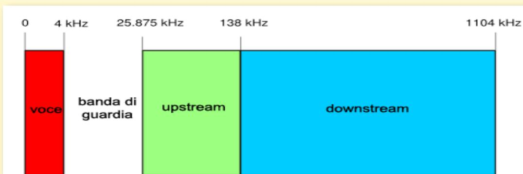
Nella tecnica ADSL è utilizzato una sola coppia di fili che interconnettono due modem. La tecnica di modulazione impiegata è la DMT (*Discrete Multi-Tone*), più nota come OFDM (*Orthogonal Frequency-Division Multiplexing*). Nella centrale telefonica è installato un dispositivo denominato DSLAM (*Digital Subscriber Line Access Multiplexer*) che aggrega i segnali relativi a più linee ADSL (tipicamente 20 o 50 linee) ed è collegato con la rete dell'operatore.
