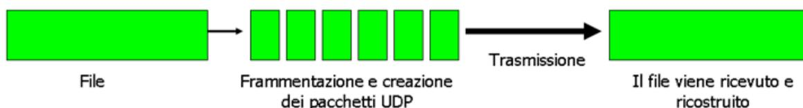
Fig. 12 - Principio del protocollo FLUTE.
