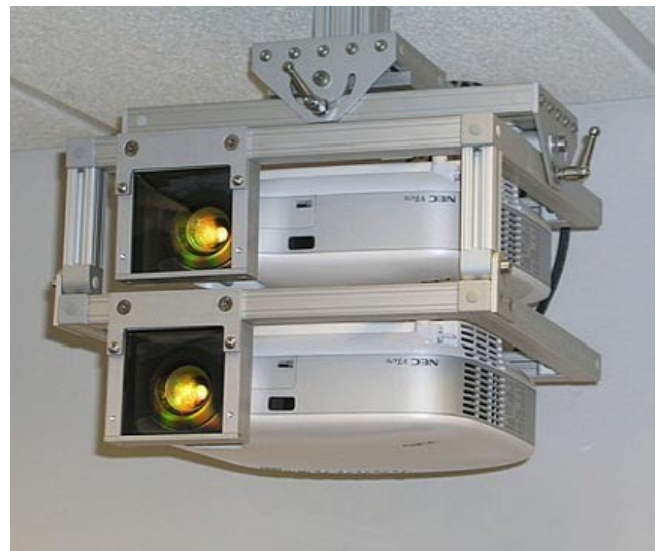
Fig. 5 - Coppia di proiettori montati su apposito supporto con filtri polarizzatori per proiezione stereoscopica
