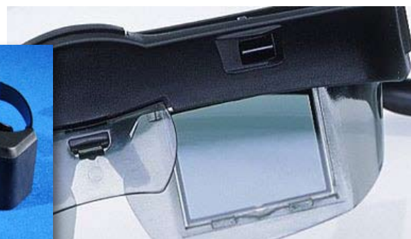
Fig. 19b – Particolare del pannello LCD di occhiali shutter. (fonte: sito sterero3d.com )
