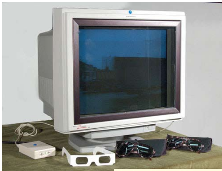
Fig. 14 – Monitor CRT con schermo polarizzatore commutabile, il relativo driver e occhiali polarizzatori.
