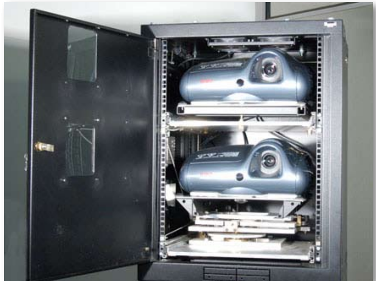
Fig. 11 – Sistema di proiezione stereoscopico basato su coppia di proiettori (in questo caso SIM2 per HDTV) in associazione a filtri polarizzatori (visibili attraverso i fori sul portello).
