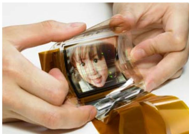
Fig. 13 - Prototipo presentato a maggio di OLED a colori su substrato flessibile: 2,5", 120x160 pixel, luminanza 100 nit, contrasto 1000:1, spessore 0,3 mm, peso 1,5 g (senza il driver) (fonte: [www.sony.co.jp](http://www.sony.co.jp))
