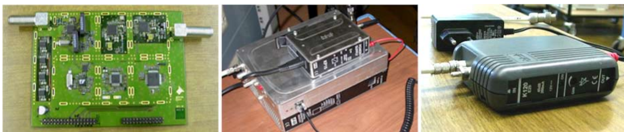
Fig. 6 – Fotografie di prototipi di ripetitori DVB H domestici
