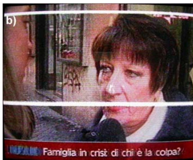
Fig. 18 – Effetti dell'oscillazione di un ripetitore DVB-H domestico sul canale TV analogico adiacente ricevuto da antenna amplificata indoor.
