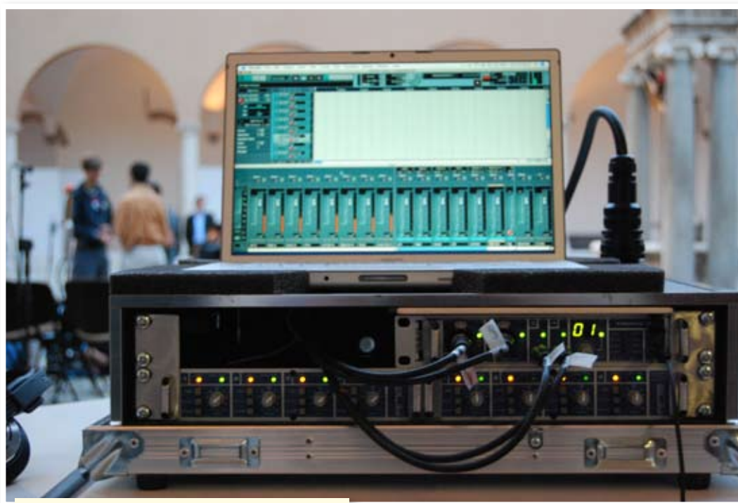
Fig. 3 – “Sistema leggero” con apparecchiature del sistema di ripresa e registrazione, contenuto nella valigia di dimensioni maggiori, mentre quella di dimensioni minori è utilizzata per alimentazione.
