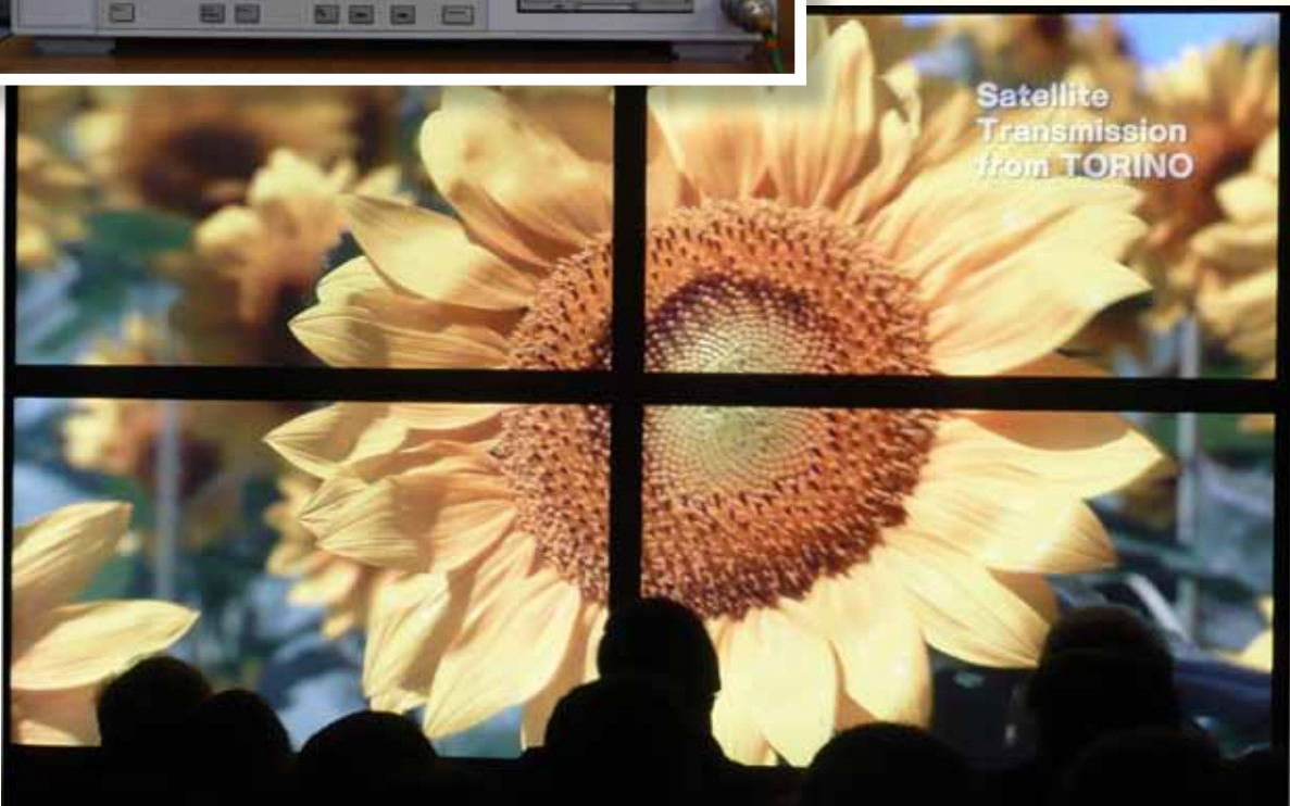
Fig. 5 - Ricezione via satellite. Immagini trasmesse dal Centro Ricerche di Torino via satellite, codificate utilizzando lo standard di compressione MPEG-4 AVC a 140 Mbit/s. Tale bit-rate è stato moltiplicato su due transponder utilizzando lo standard DVB-S2.
