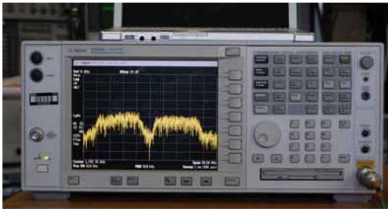
Fig. 5 - Ricezione via satellite. Immagini trasmesse dal Centro Ricerche di Torino via satellite, codificate utilizzando lo standard di compressione MPEG-4 AVC a 140 Mbit/s. Tale bit-rate è stato moltiplicato su due transponder utilizzando lo standard DVB-S2.
