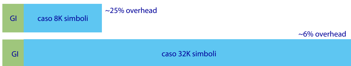
Fig. 10 - Rappresentazione della durata del simbolo nel caso di 8K e 32K portanti. In entrambi i casi l'intervallo di guardia è circa 224 μs e consente la realizzazione di SFN con distanza tra i trasmettitori di circa 70 km.
