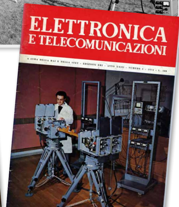
1974 - Ponte radio doppio di tipo portatile, per riprese esterne TV anche a colori.
