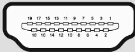
Fig. 13 - Connettore HDMI tipo A, da 19 contatti.
