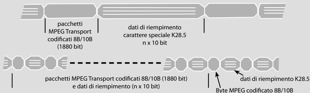
I byte sono codificati mediante un codice a gruppo che associa 10 bit ogni byte (8B/10B), in modo da consentire la rigenerazione del clock la rilevazione della presenza di errori; il sincronismo è ottenuto mediante una parola da 10 bit non compresa fra quelle generate dal codice.
