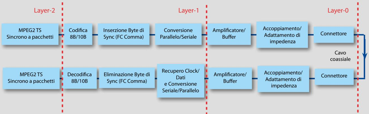
Fig. 9 - Esempio di applicazione dell'interfaccia DVB-ASI.
