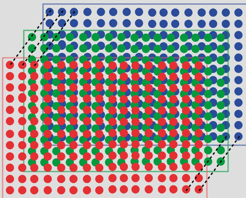
Fig. 1 - Nel caso di struttura di campionamento 4:4:4, le tre componenti sono campionate alla stessa frequenza e i tre campioni corrispondenti allo stesso elemento di immagine sono co-posizionati: ad esempio, nel caso di RGB i campioni rosso, verde e blu hanno lo stesso reticolo di campionamento.
