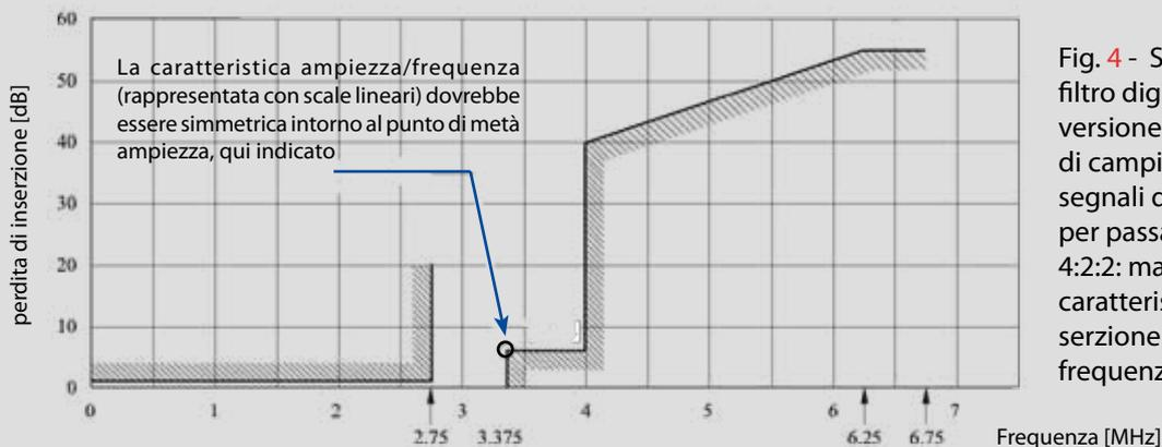
Fig. 4 - Specifiche per un filtro digitale per la conversione dalla frequenza di campionamento dei segnali differenza-colore per passare da 4:4:4 a 4:2:2: maschera per la caratteristica perdita d'inserzione in funzione della frequenza.
