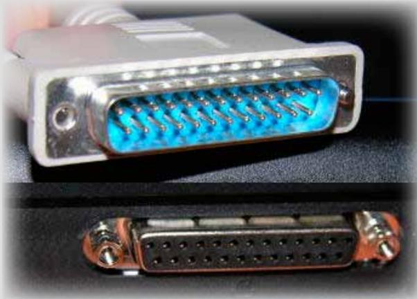
Fig. 2 - L'interfaccia parallela prevedeva connettori 25-pin D-subminiature e cavi costituiti da 11 doppi (twisted pair), 10 per ciascuno dei bit relativi all'informazione video più uno per il clock. Il cavo poteva raggiungere i 50 m senza equalizzazione e 200 m con appropriata equalizzazione.
