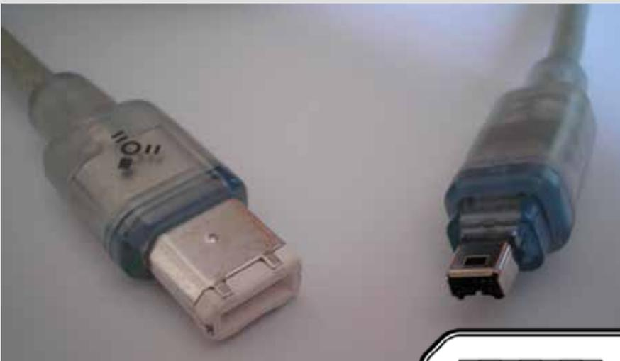
Fig. 14 - Cavi IEEE 1394 con connettori a 6 e 4 pin.
