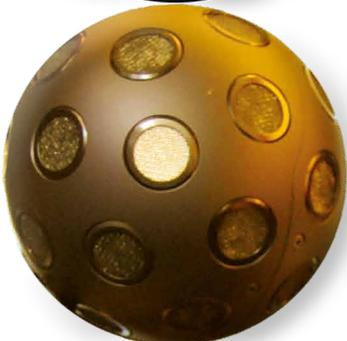
Il sistema denominato 3D-VMS, basato sulla teoria Ambisonic, utilizza una sonda a più capsule per realizzare la ripresa multimicrofonica e consente di posizionare più punti di ripresa sul piano azimutale e mediano (fino a 7 microfoni virtuali).
