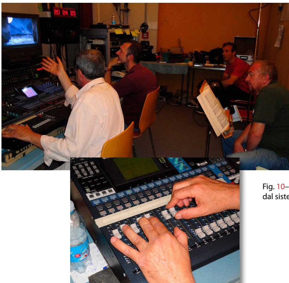
Fig. 10– Mixaggio dei 7 segnali ottenuti in live dal sistema 3D VMS e dei microfoni della fossa.
