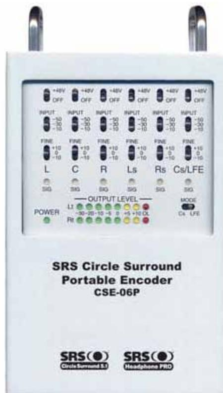
Fig. 17 – Codificatore CSE-06P della SRS Labs.
